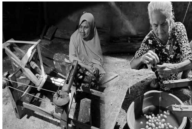
Gambar 4. Aktivitas Pemintalan Benang Sutra dari Kokon Menggunakan Alat Pintal Tradisional
